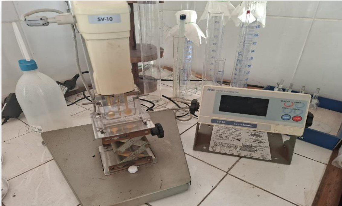
Figura 2.17. Viscositatea dinamică înregistrată a uleiului de cânepă presat la rece folosind echipamentul AND SV-10 Vibro Viscometer
