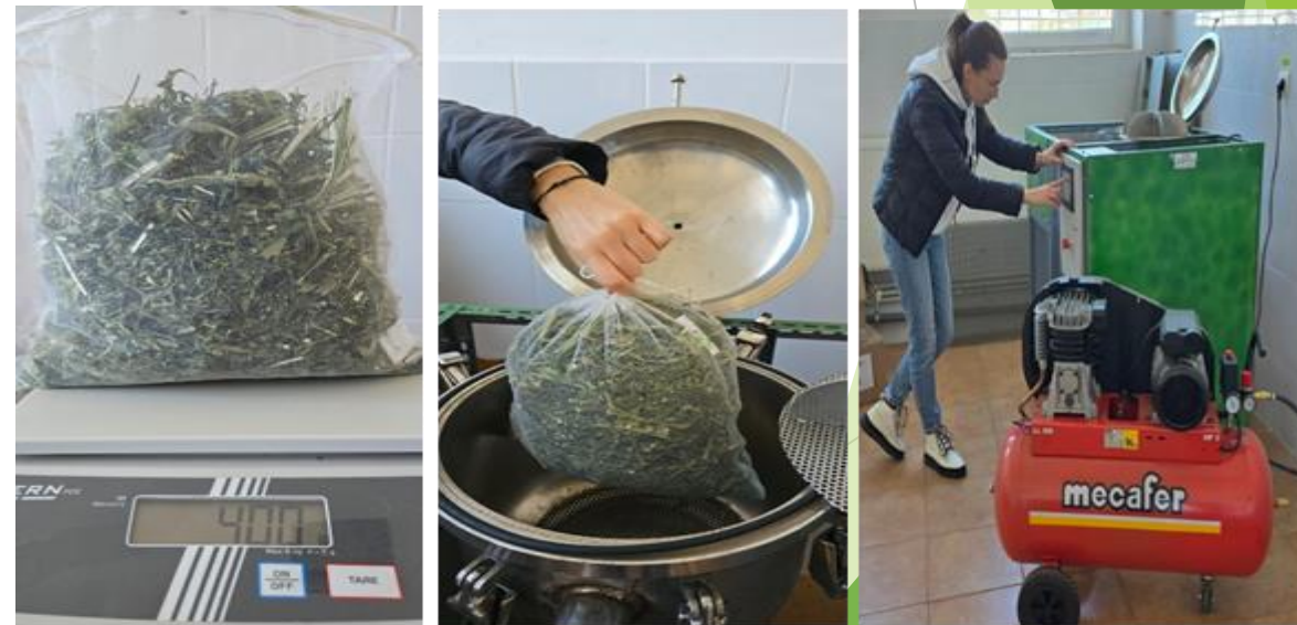
Figura 1.16. Cântărirea, umplerea sacilor permeabili de infuzare și setarea parametrilor de proces în vederea extracției
