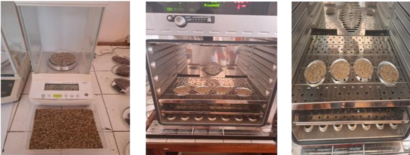
Figura 2.1. Imagini din timpul evaluării umidității semințelor de cânepă destinate presării la rece
